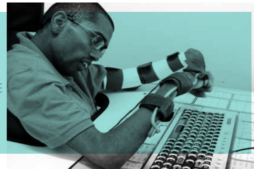
Marcos com o estabilizador de punho (órtese) e a colmeia acoplada no teclado - adaptação física e de hardware
